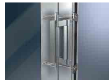
Verdeckt liegendes Türband mit 100°-Öffnungswinkel für hohe architektonische Ansprüche und Barrierefreiheit
