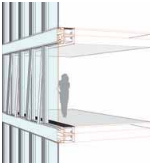
Ventanas de apertura hacia fuera sobre eje vertical Projected top-hung windows
