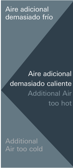
Fig. 16: Limitación de la ventilación natural de la ventana a través de la temperatura del aire exterior y condensación en las diferentes zonas climáticas: en el hemisferio norte, existe peligro de desperdicio de energía y el confort se ve afectado, además existe el riesgo de condensación en invierno en el norte ("demasiado frío") y en verano en el sur ("demasiado caliente y húmedo")
