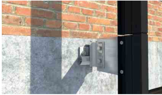
2. Baukörperanschluss durch Montage der Lisene inklusive Befestigungskonsole 2. Attach to building structure by mounting plaster strips with fixing bracket
