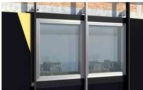
4. Abdichtung und Dämmung zum Baukörper 4. Installation and sealing on the building structure
